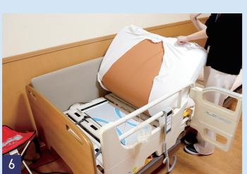
**5 | 6 眠りSCANはベッドのマットレスの下に敷くセンサーで、利用者の眠りを妨げることなく使用できる。センサーは心臓の拍動や呼吸、体動を測定し、利用者の覚醒・睡眠状態を可視化するだけでなく、睡眠データを蓄積することができ、ケアの方針を検討する際の参考データとして活用できる。**
