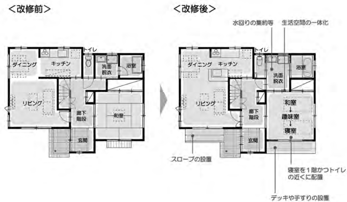
図6 「高齢期の健康で快適な暮らしのための住まいの改修ガイドライン」に基づく改修例
